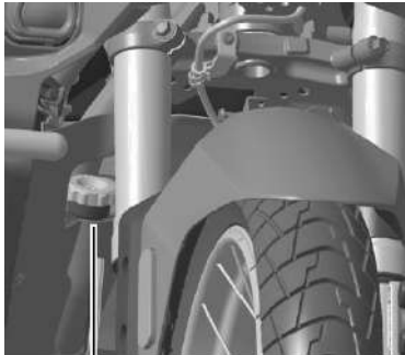
Boca de llenado del vaso de expansión
